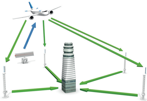
Bild 7: Prinzip des Austrian Wide Area Multilateration Systems (AWAM)
